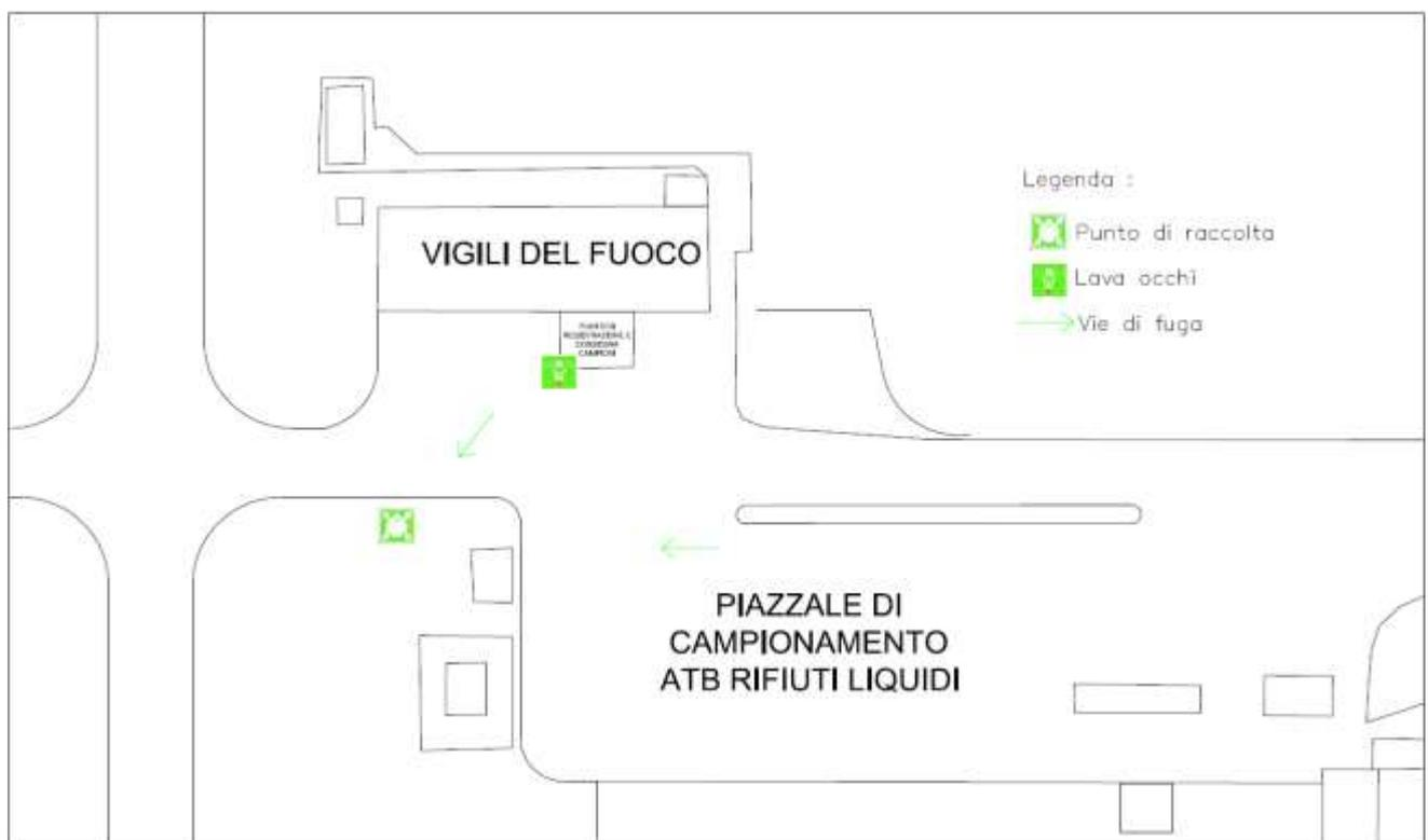
**Fig. 3:** Stralcio planimetrico piazzale di campionamento della rimessa antincendio con l'indicazione dell'ubicazione del punto di raccolta e l'ubicazione delle colonnine lavaocchi
